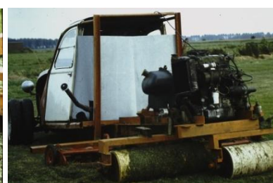
De 5 kooien werden apart aangedreven door de motor van een Mini Cooper (gekregen van afd. autotechniek LTS).
