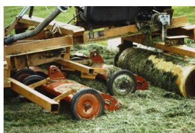
De 5 kooien werden apart aangedreven door de motor van een Mini Cooper (gekregen van afd. autotechniek LTS).
