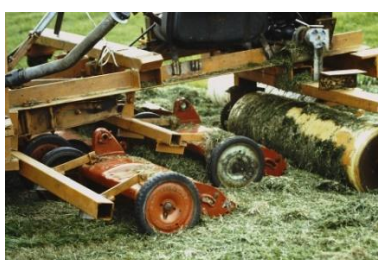
De 5 kooien werden apart aangedreven door de motor van een Mini Cooper (gekregen van afd. autotechniek LTS).
